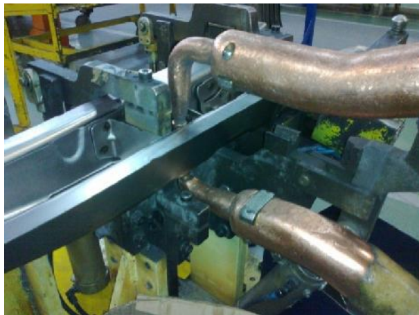
Figura 33 - Aplicación soldadura de punto 2
