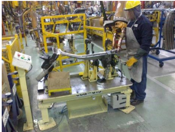
Figura 32 - Aplicación soldadura de punto
