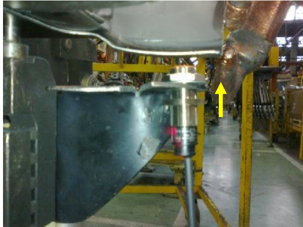
Figura 30 - Modificación en la posición del sensor
