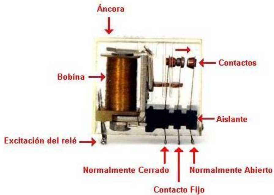
Figura 5 Relevador de corriente alterna
