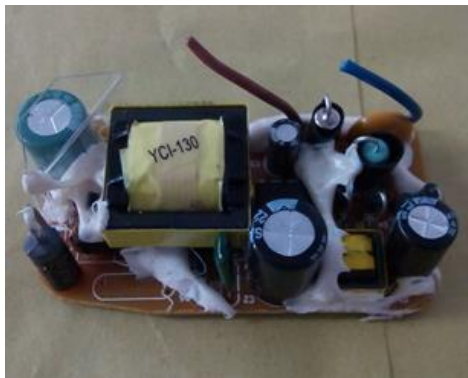
Figura 8 Fuente de voltaje
