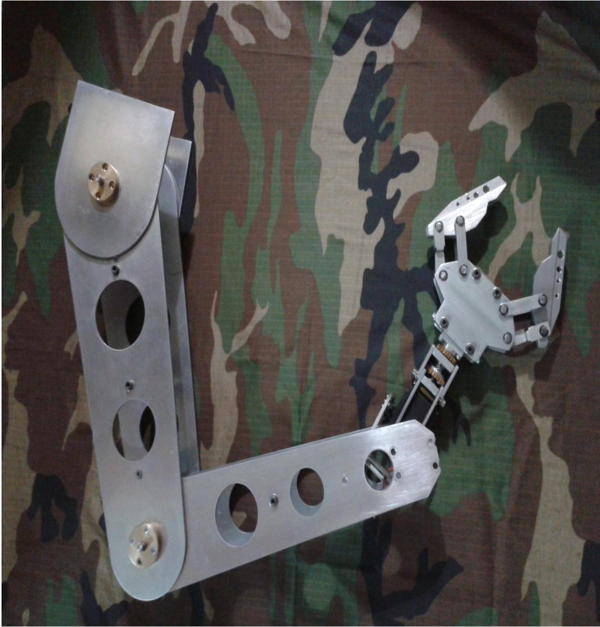
FOTO 4. ENSAMBLE DE ANTEBRAZO, BRAZO Y PINZA DE SUJECIÓN.
