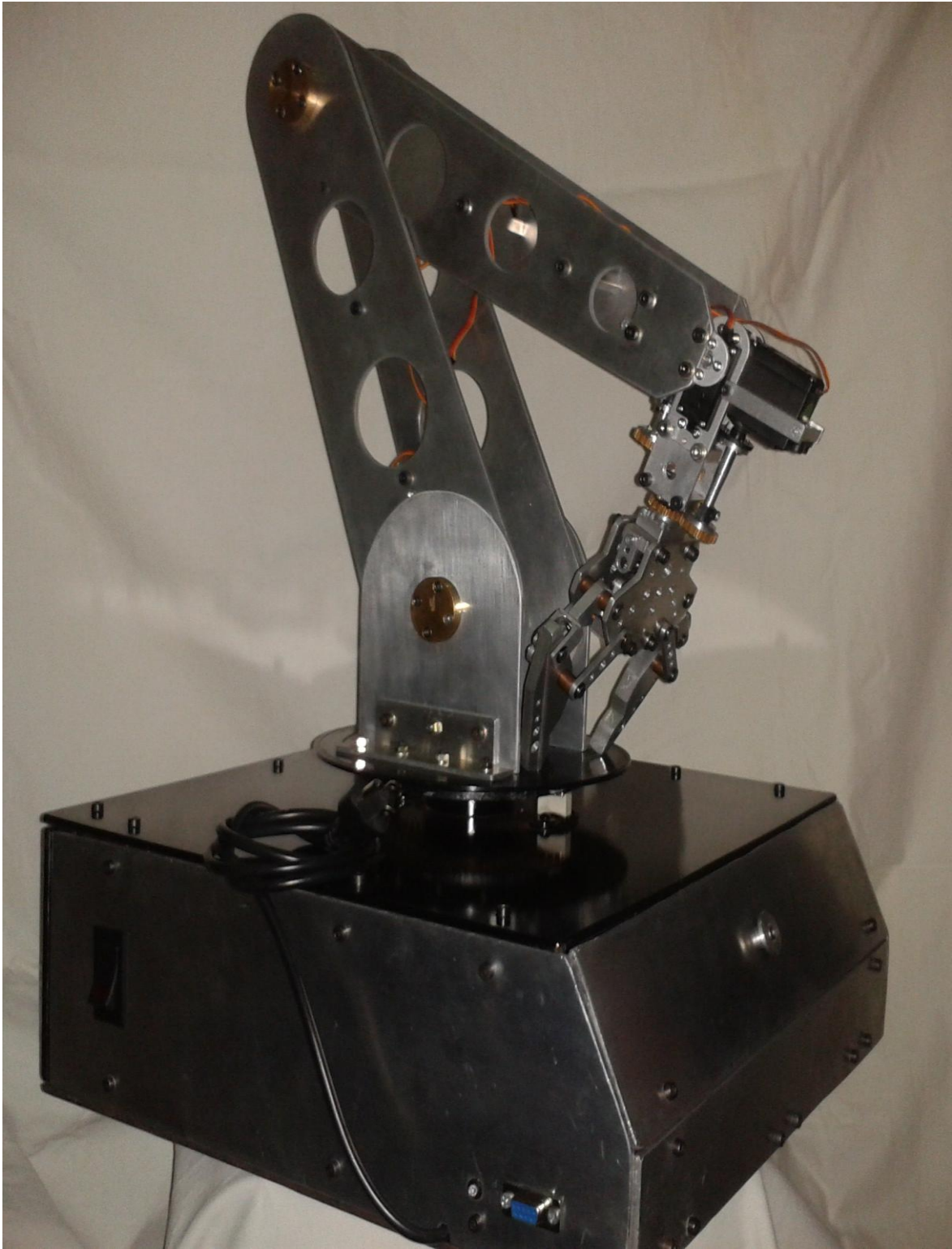
FOTO 7. BRAZO ROBOTICO TIPO P.U.M.A TERMINADO.
