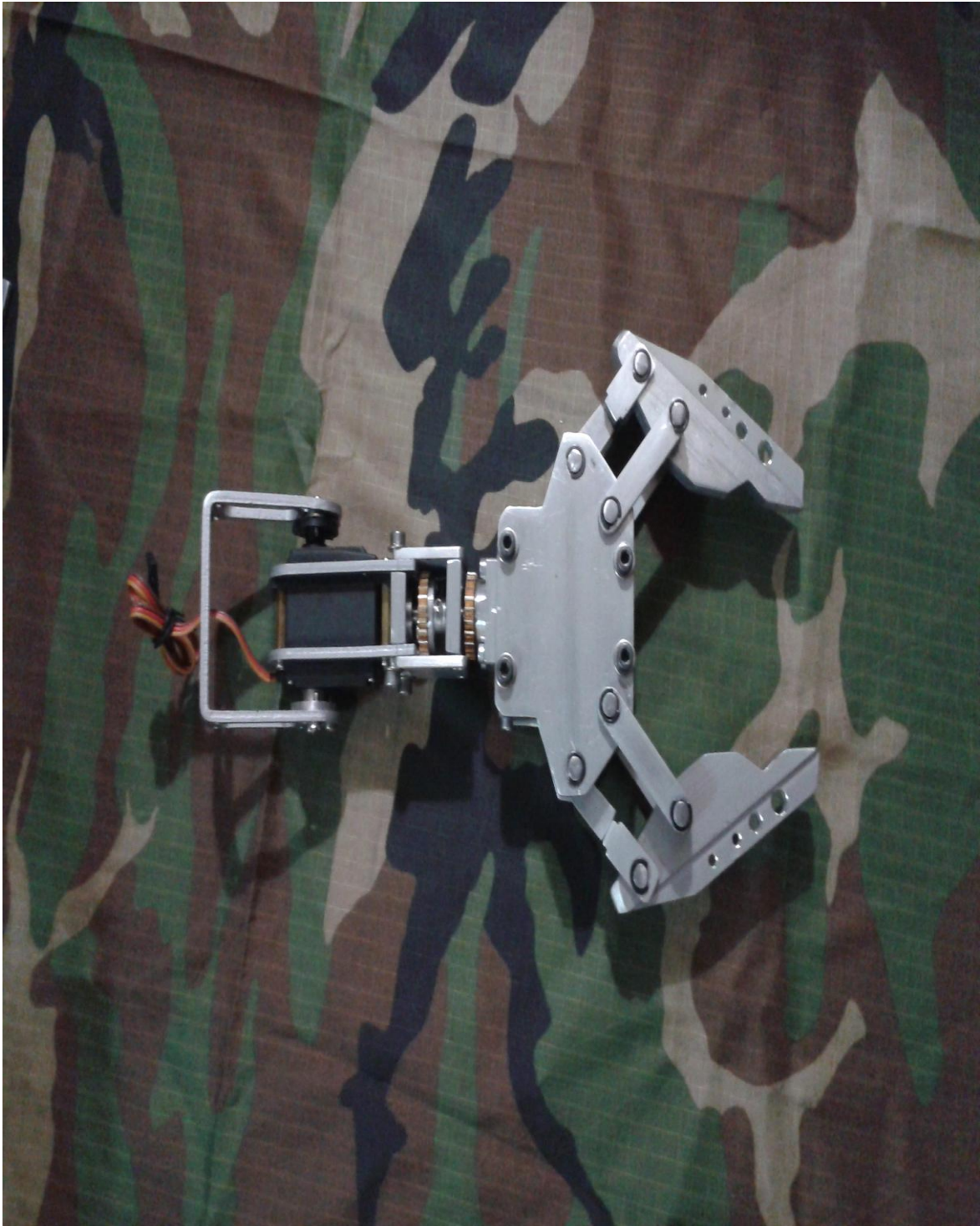
FOTO 3. ENSAMBLE DE PINZA DE SUJECIÓN CON SERVOMOTOR.
