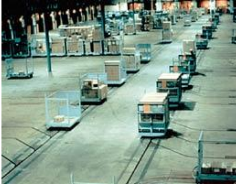
Imagen 23. Cintas por cable enterrado
