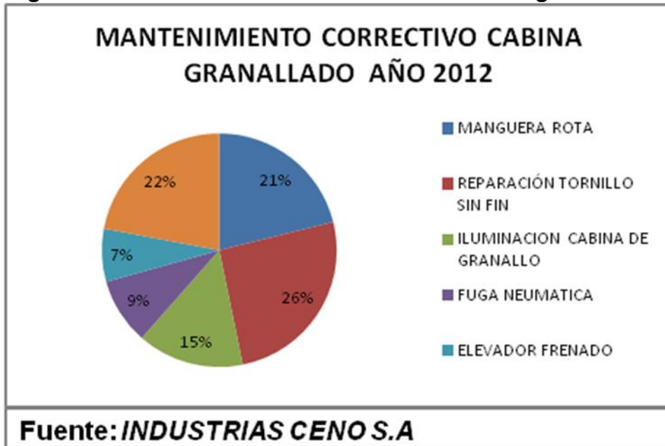
Figura 2. Grafica de mantenimiento correctivo en granalladora.
