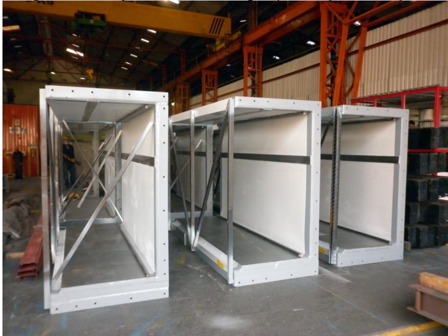
Imagen 13. Proyecto Hidroituango. (Guías para compuertas)
