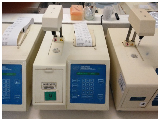
Ilustración 29 Equipo para hacer crioscopia
