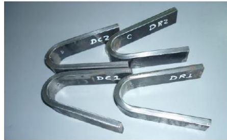
Fotos 4 a 9. Proceso de doblez de cara y de raíz.
