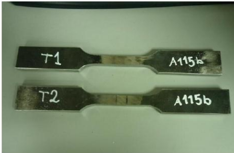
Foto 10. Probetas para ensayo de tracción
