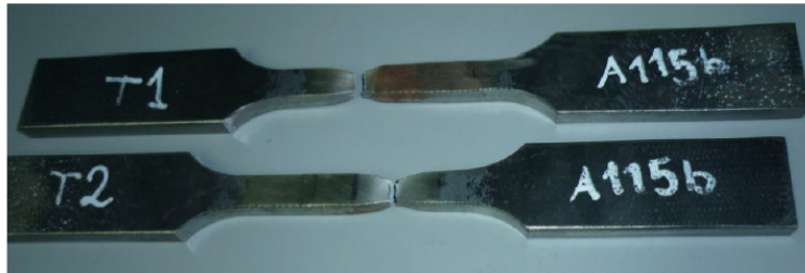
Foto 11. Probetas reventadas luego del ensayo de tracción.
