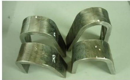
Fotos 4 a 9. Proceso de doblez de cara y de raíz.
