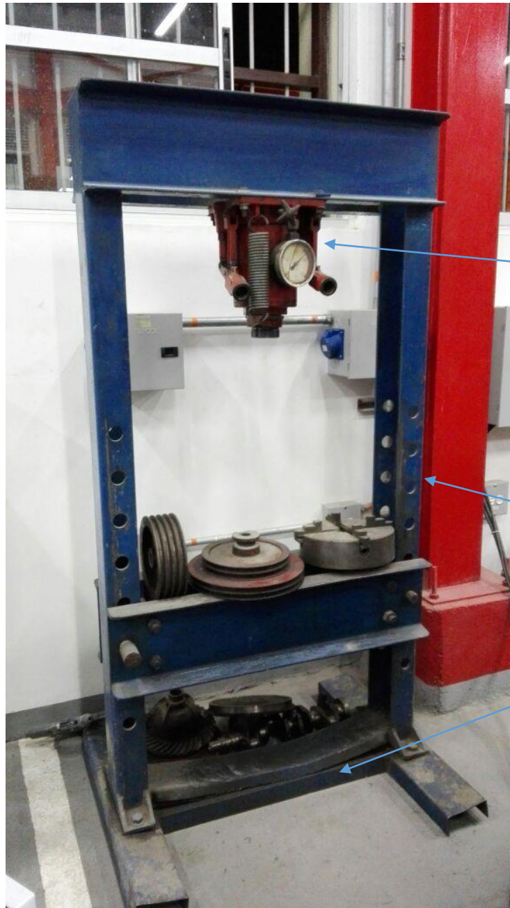
Imagen 8. Estado inicial de la prensa tipo H (fuente universidad universitaria pascual bravo)
