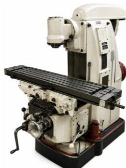
Ilustración 13. Fresadora universal FWD 250. Fuente: Propia, a partir de la máquina utilizada en el proceso.
