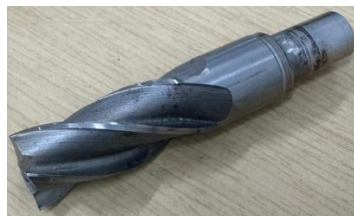
Ilustración 18. Broca fresa plana de \frac{5}{8} " (15.88 mm). Fuente: Propia, a partir de la herramienta utilizada en el proceso
