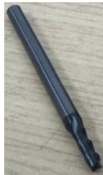
Ilustración 19. Broca fresa plana de 3 mm. Fuente: Propia, a partir de la herramienta utilizada en el proceso.
