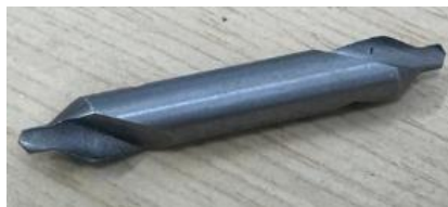
Ilustración 11. Broca Centro #3. Fuente: Propia, a partir de la herramienta utilizada en el proceso.
