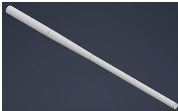
Ilustración 3. Modelado del cuerpo del tornillo extrusor. Fuente: Propia, obtenida con el software Inventor.
