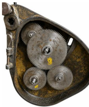
Ilustración 16. Caja de guitarra. Fuente: Propia, a partir de dispositivo
