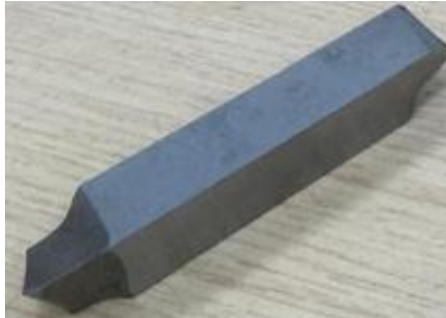
Ilustración 9. Buril de acero rápido con punta de diamante. Fuente: Propia, a partir de la herramienta utilizada en el proceso.
