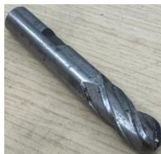
Ilustración 20. Fresa de punta redonda de \frac{3}{8} " (9.53 mm). Fuente: Propia, a partir de la herramienta utilizada en el proceso.
