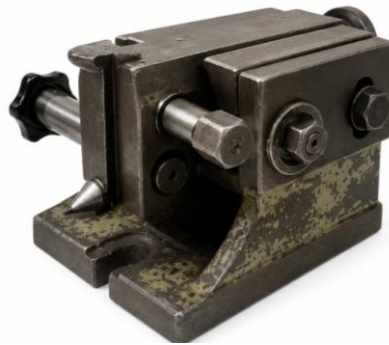
Ilustración 17. Contrapunta de fresadora. Fuente: Propia, a partir del dispositivo utilizado en el proceso.
