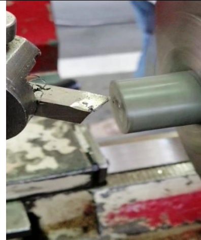
Figura 19 Refrentar eje secundario. Fuente: Propia
