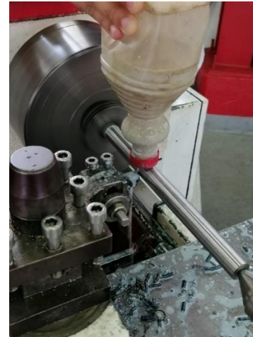
Figura 20 Refrentar eje secundario. Fuente: Propia
