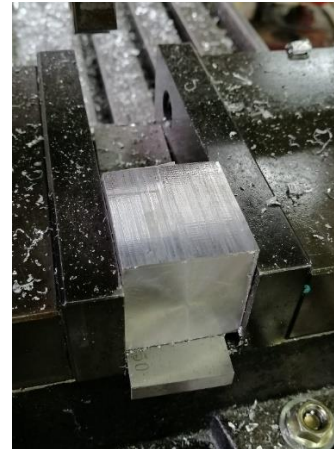
Figura 22 Cubo de aluminio terminado. Fuente: Propia
