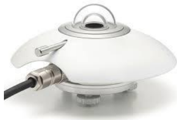
Figura 3. Piranómetro a usar sobre la base diseñada
