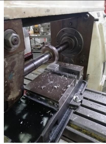
Figura 21 Mecanización de cubo. Fuente: Propia
