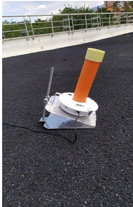
Figura 4. Piranómetro con generador de sombra
