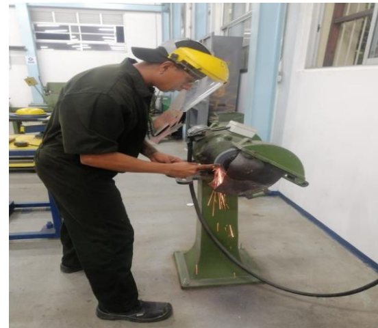
Figura 12 Pulir tubos. Fuente propia
