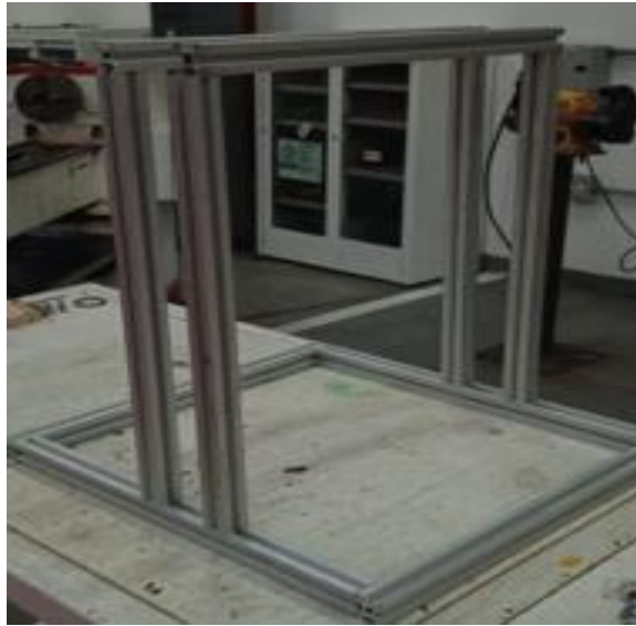
Figura 10. Estructura mecánica de la troqueladora. Fuente. Diseño propio.
