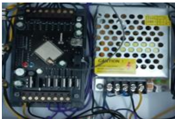
Figura 12. Controlador y fuente de la troqueladora. Fuente. Diseño propio.
