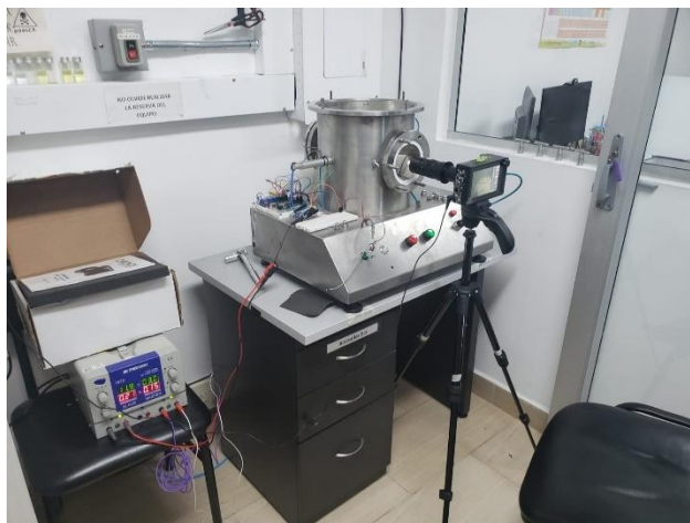
Ilustración 14 Montaje real de prueba de gotas en el laboratorio de ciencias térmicas
