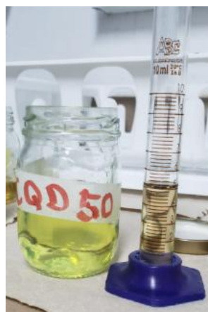
Ilustración 9 Dispersión de puntos cuánticos de carbono en concentración de 50mg/L
