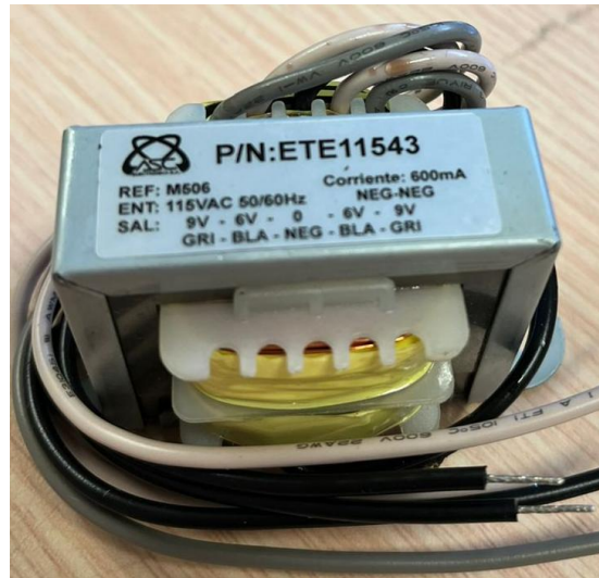
Figura 9. Transformador 5.4 VA ETE11543 Fuente: Registro propio
