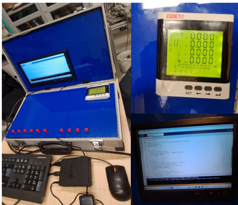
Figura 8. Prueba de módulo HIL implementado
