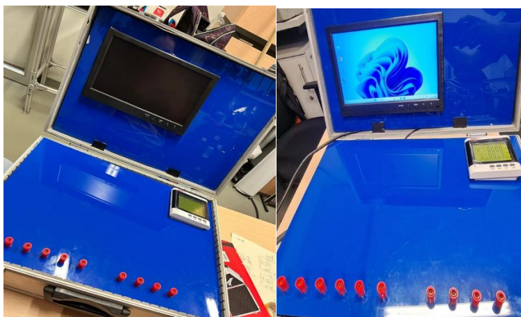
Figura 7. Prueba de pantalla HMI, bornes y medidor multifuncional
