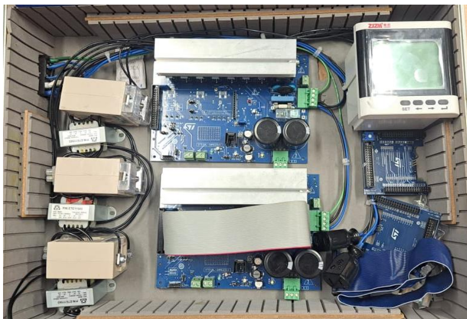
Figura 5. Conexiones de placas ST Nucleo-F302R8 y medidor multifuncional Fuente: Registro propio
