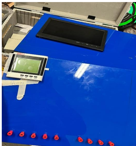
Figura 6. Implementación de pantalla HMI, bornes y medidor multifuncional Fuente: Registro propio
