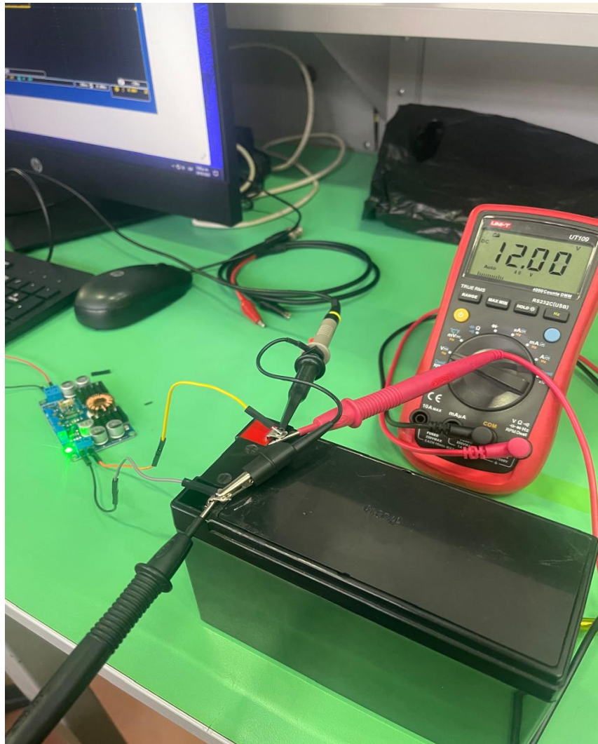
Figura 5. Conexión de batería con suministro de tensión. Fuente: elaboración propia.
