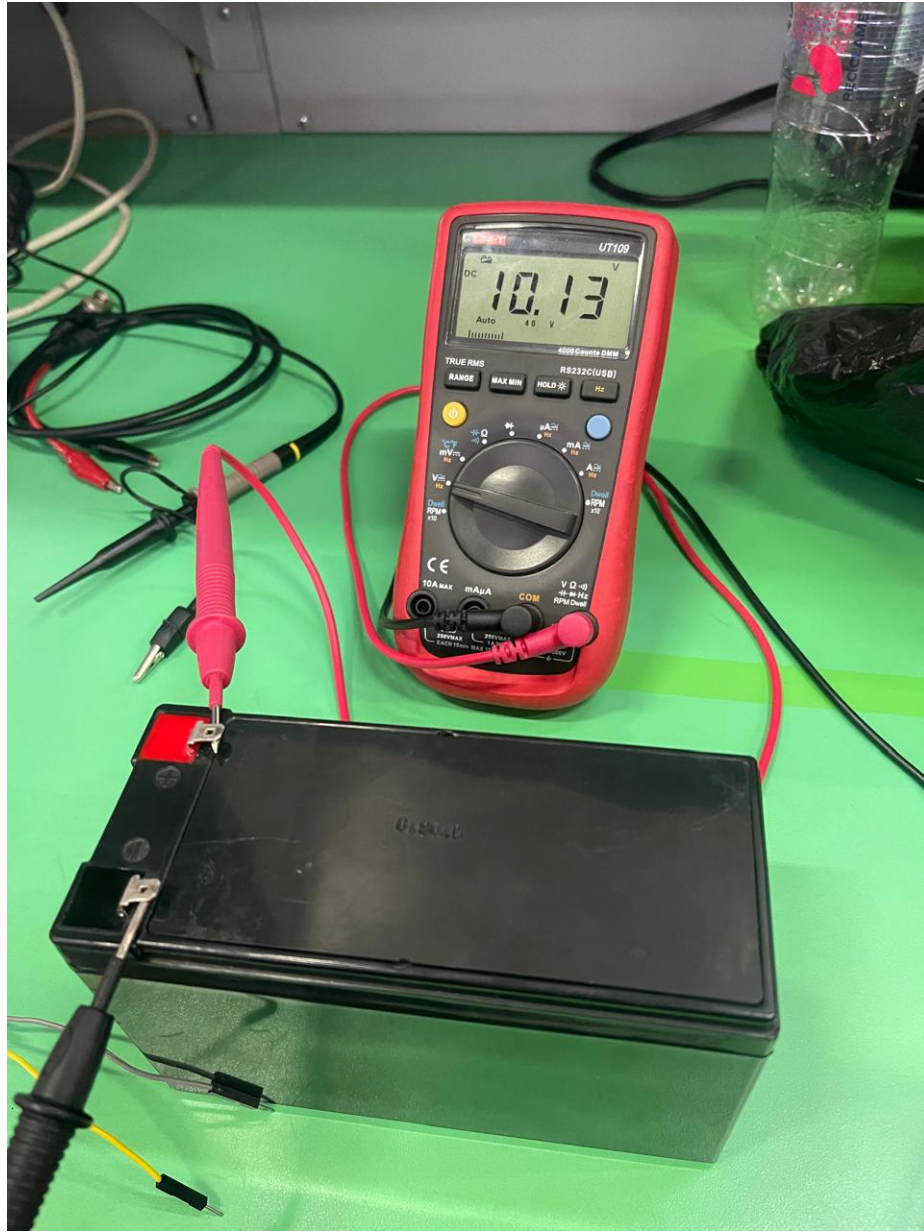
Figura 6. Tensión de batería después de 5 minutos de carga. Fuente: elaboración propia.
