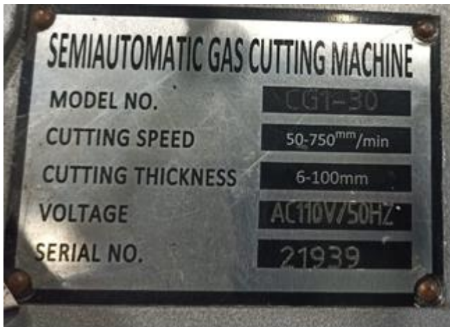
Figura 6. Placa de especificaciones técnicas del equipo semi automático para corte
