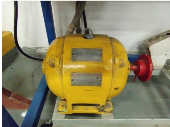
Foto 16 Motor de inducción con rotor en jaula, las placas no son legibles.
