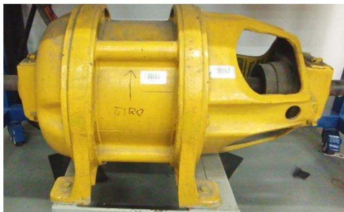
Foto 43 Motor de inducción en jaula adaptado a una carcasa de rotor devanado
