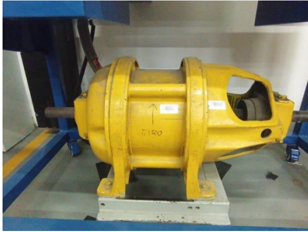
Foto 9 Motor de inducción con rotor en jaula, sin ficha técnica.
