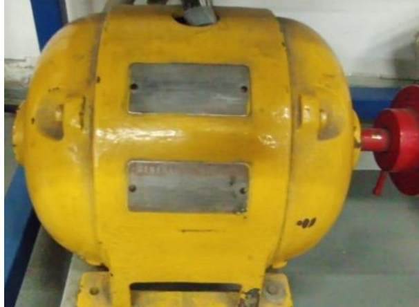
Foto 44 Motor de inducción trifásico con rotor en jaula con conexiones en el panel didáctico
