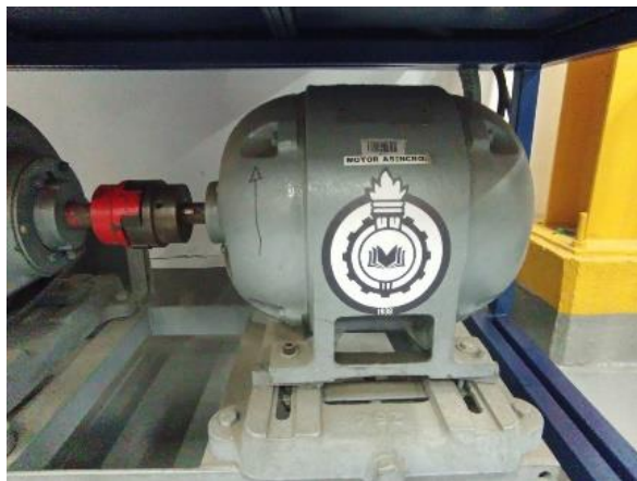
Foto 26 Motor de inducción con rotor en jaula sin placa
