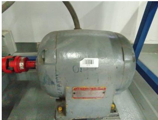
Foto 22 Motor de inducción con rotor en jaula. Ficha técnica no legible y en mal estado
