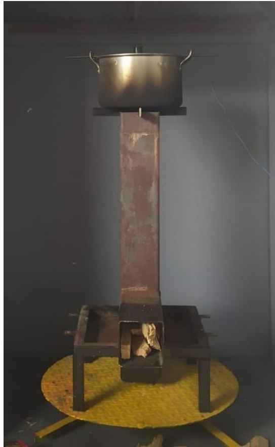
Figura 7. Estufa tipo cohete con modificaciones iniciales
