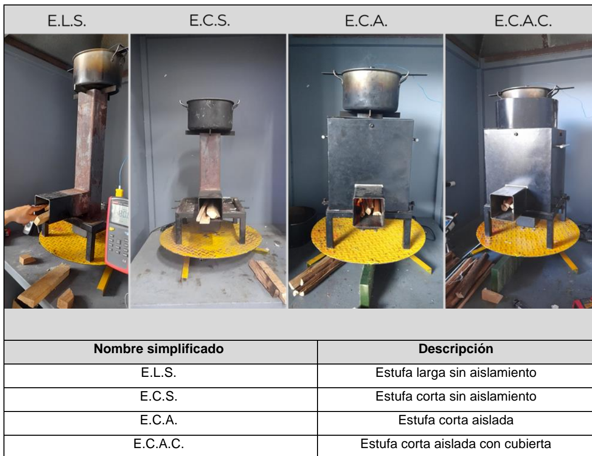
Figura 8. Imágenes reales de las modificaciones realizadas.
