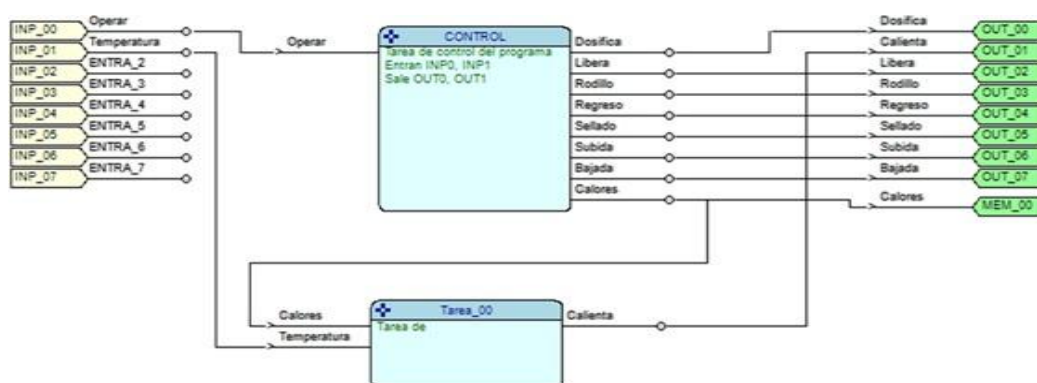
Figura 8 Diagrama de entradas y salidas del control Fuente: diseño propio
