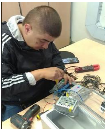
Figura 12 Armado y pruebas de correcta conexión del tablero de control automático Fuente: propia
