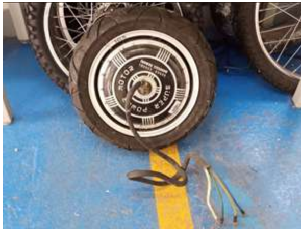
Motor eléctrico tipo brushless para aplicaciones automotrices
