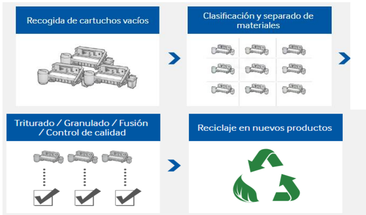
Figura 4: Proceso de reciclado de Cartuchos tóner
