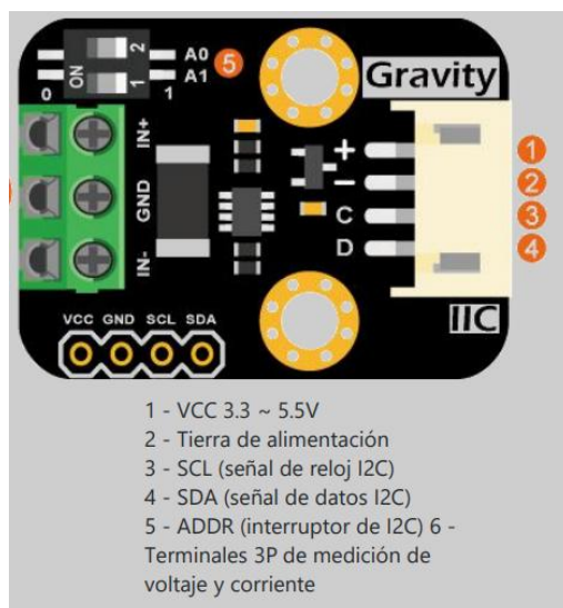
Figura 12. Sensor de corriente SEN0291
