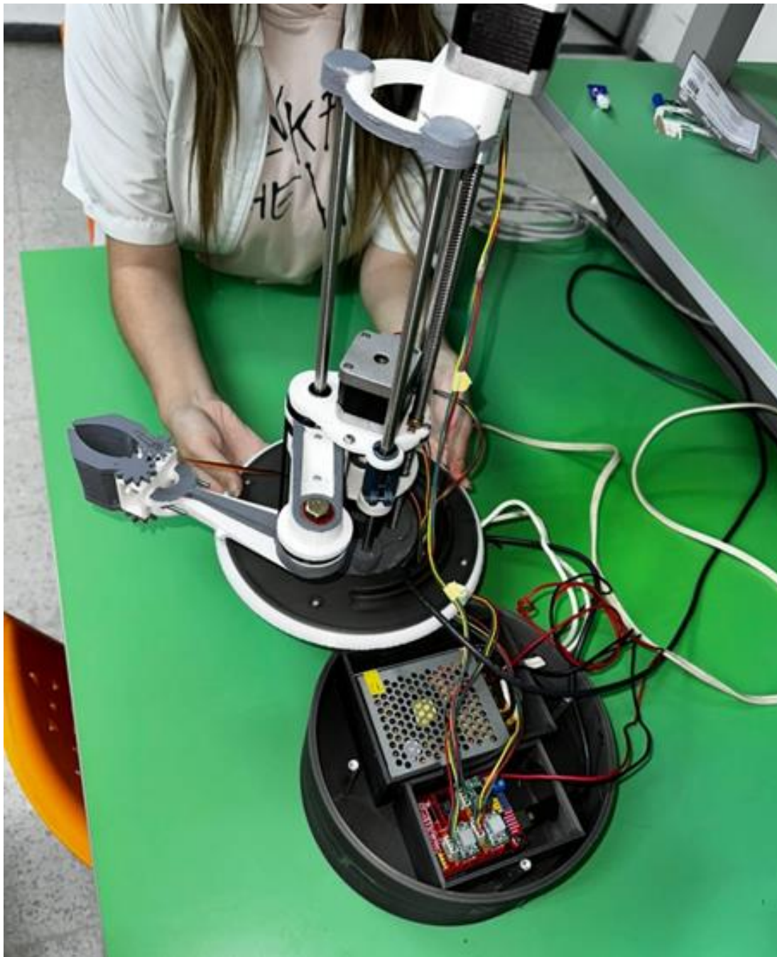
Figura 64. Montaje eléctrico Fuente: diseño propio
