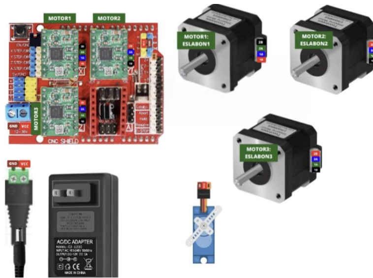
Figura 62. Conexiones eléctricas Fuente: diseño propio
