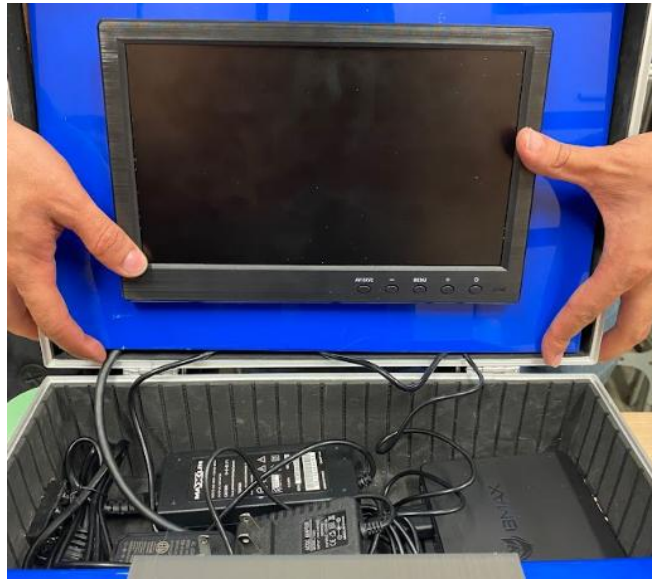
Figura 25. Disposición interna del computador y las fuentes de alimentación. Fuente: Propia.
