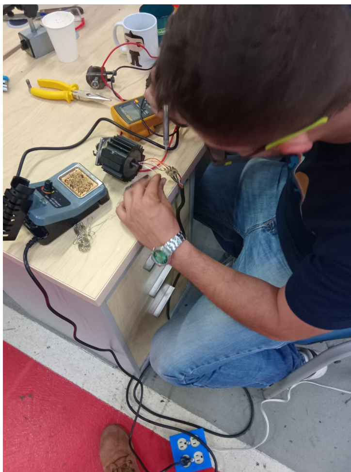
Figura 3.3.2: Proceso de soldadura y comprobación eléctrica en el motor del torno durante la repotenciación (Elaboración propia).
