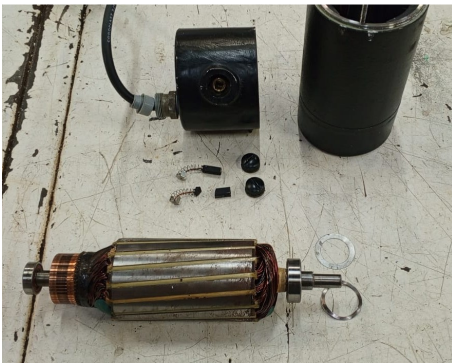
Figura 3.1.3: Vista del motor del husillo principal durante el proceso de inspección.
