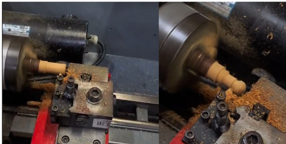
Figura 4.2.14: Ejecución del maquinado en el torno CNC durante la fabricación de la pieza.
