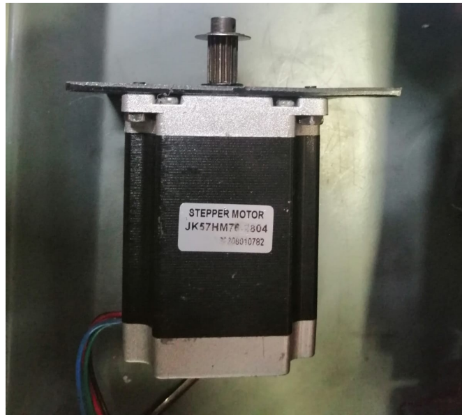
Figura 3.1.6: Motor paso a paso NEMA 23 utilizado para el accionamiento de los ejes del torno.
