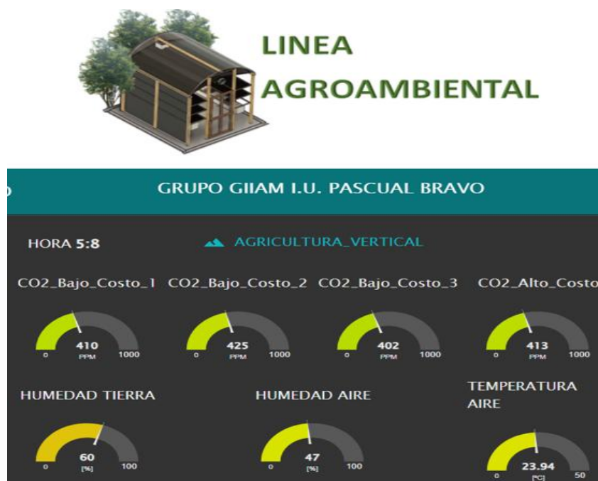
Ilustración 4 Dashboard construido en la plataforma NODE-RED
