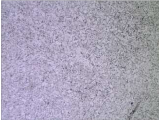
Figura 27. Metalografía de pared de acero al carbon, tramo 1 (Mas cerca del material base)
