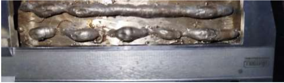
Figura 23. Cordones de soldadura con modo de transferencia combinado de globular y spray
