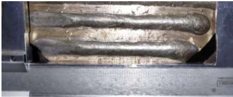
Figura 24. Cordones de soldadura con modo de transferencia de spray
