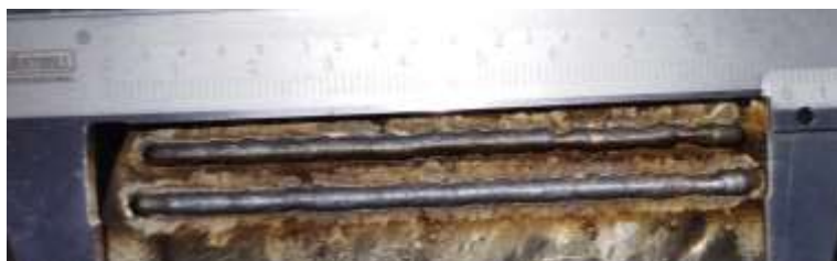
Figura 20. Cordones de soldadura con modo de transferencia de corto circuito
