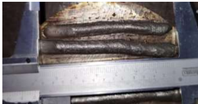
Figura 22. Cordones de soldadura con modo de transferencia de globular
