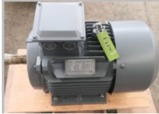
Figura 13. Ilustración que presenta, Generador eléctrico AC.
