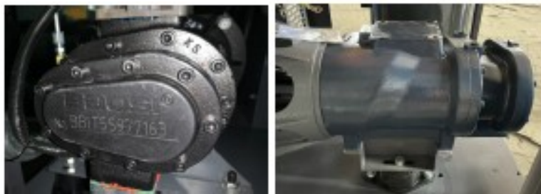
Figura 12. Ilustración que presenta, compresor neumático tipo tornillo.
