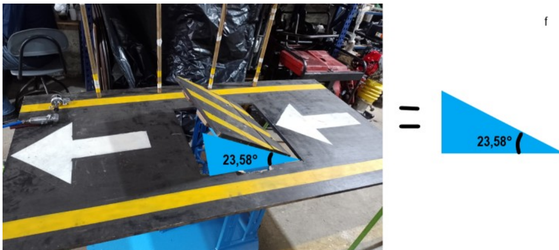
Figura 16. Ilustración que presenta, el ángulo de la rampla de prototipo manual. Fuente. Autor
