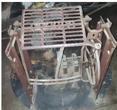
Figura 8. Ilustración que presenta, máquina de coser de pedal modificada.
