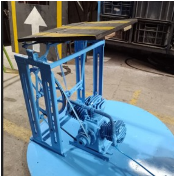
Figura 17. Ilustración que presenta, sistema biela-manivela. Fuente. Autor
