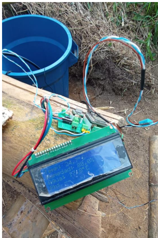
Figura 23. Sistema de monitoreo conectado y funcionando Fuente: elaboración propia
