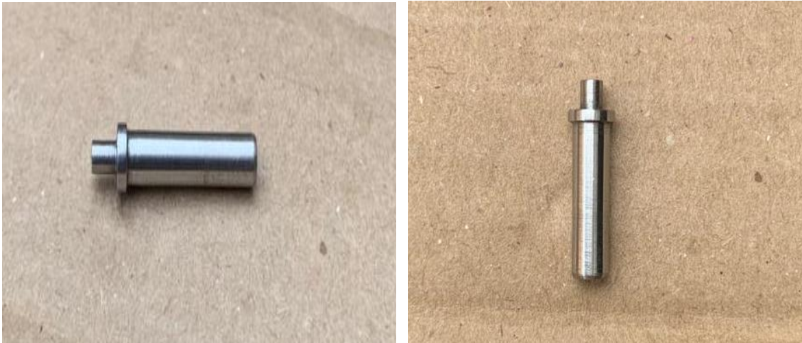
Ilustración 22 Punzón cremallera después de mecanizado.
