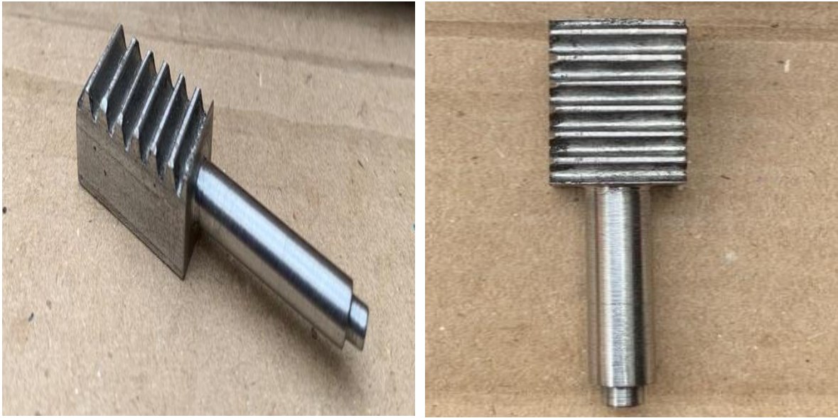
Ilustración 24 Cremallera después de mecanizado.
