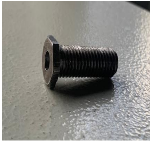
Ilustración 28 Buje pasante después de mecanizado.
