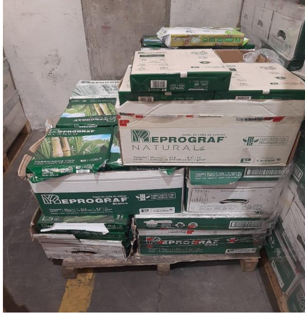
Ilustración 1. Mal proceso de estiba de mercancía en bodega. Fuente propia, (2024)
