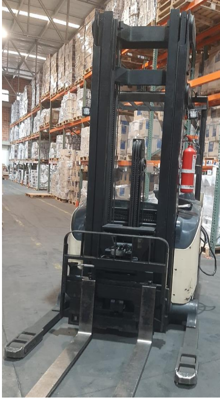
4 Montacarga doble profundida
