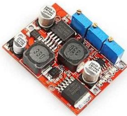
Figura 31. Tarjeta elevadora de voltaje LM2577S
