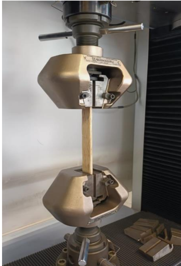
Figura 48. Montaje de ensayo de tensión en el compuesto.
