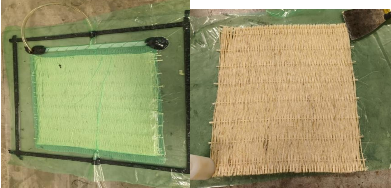
Figura 46. Proceso de infusión y polimerización del PVA en el tejido de fibra de fique
