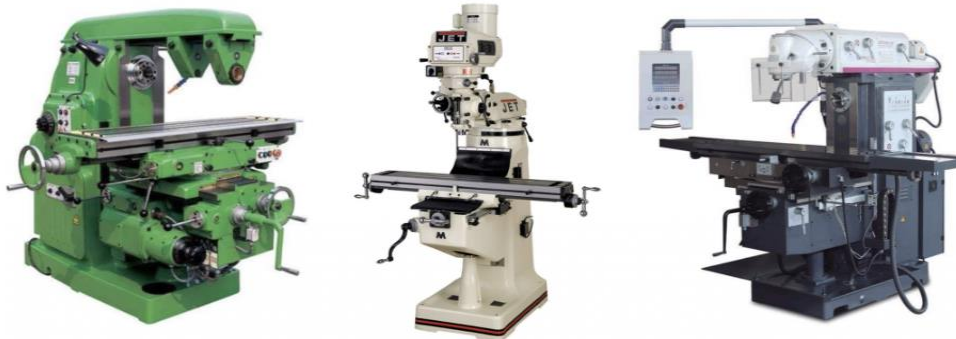
Figura 4. Tipos de fresadoras según su husillo: a) fresadora horizontal; b) fresadora vertical y c) fresadora universal. Fuente: (Bitfab, 2023).
