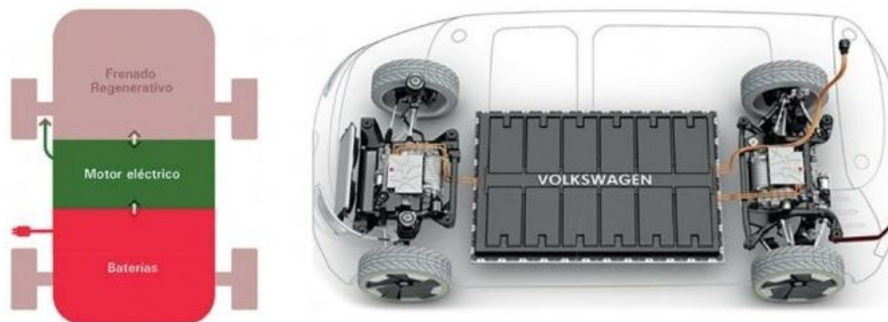
Figura 3. Vehículo eléctrico de baterías (EV)
