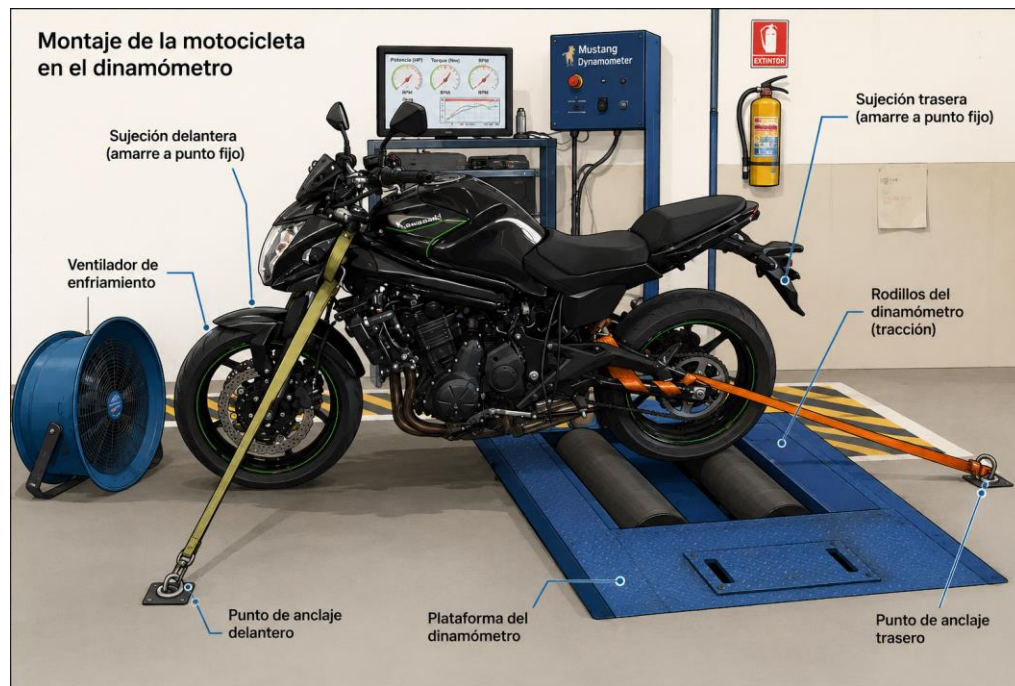
Ilustración 1. Montaje de la motocicleta en el dinamómetro.
