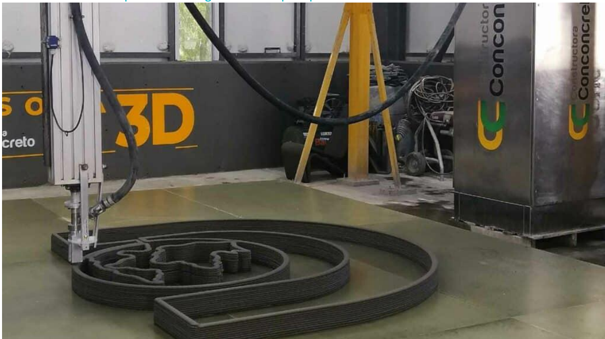
Ilustración 10: Impresora 3D de gran formato par aplicaciones de Construcción de vivienda
