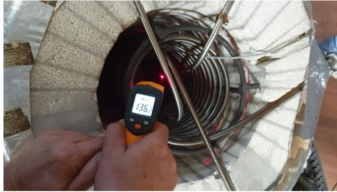
Figura 7. Vista del reactor con toma de temperatura directa.
