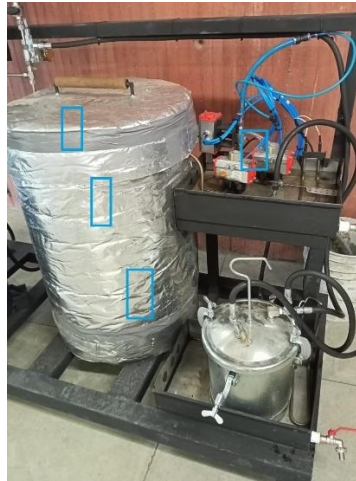
Figura 4. Recuadros azules, posición de las termocuplas.
