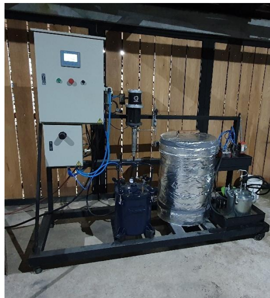
Figura 5. Prototipo físico del sistema de licuefacción hidrotermal (HTL)
