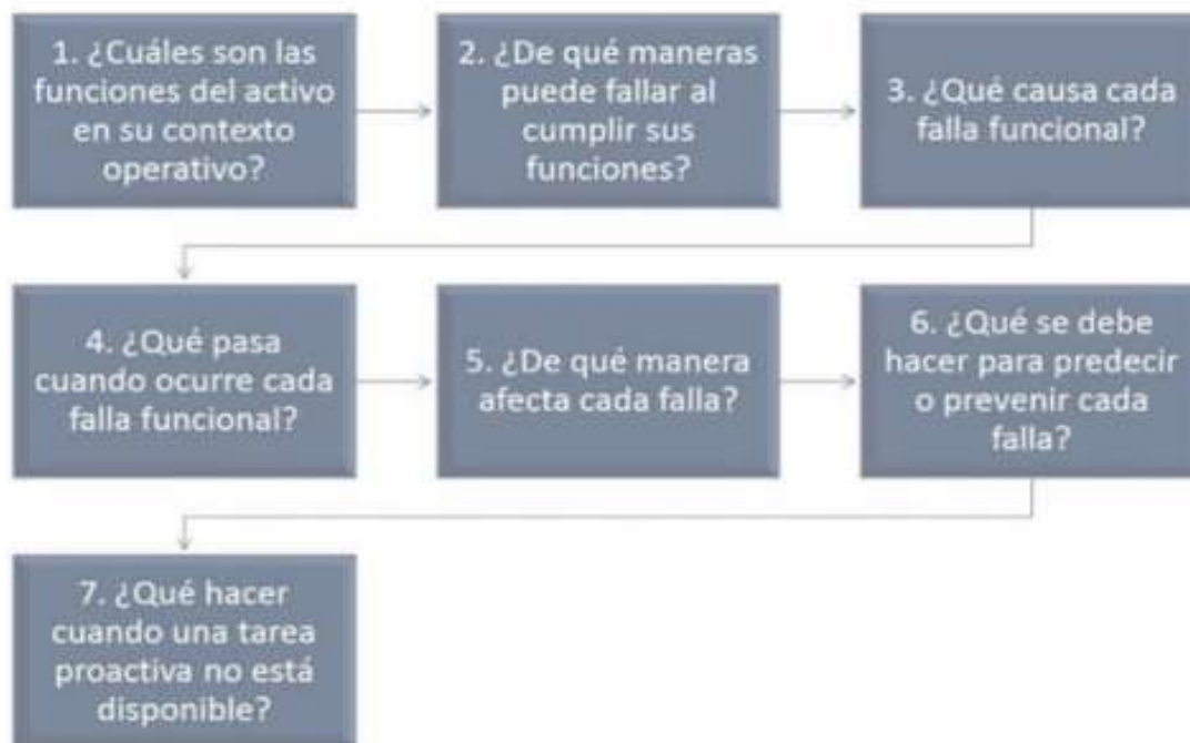
Figura 5. Proceso de mantenimiento centrado en la confiabilidad.
