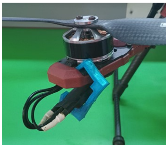
Figura 3.1.3: Soporte del motor con abrazadera de sujeción de cables. (Fuente: Elaboración propia)
