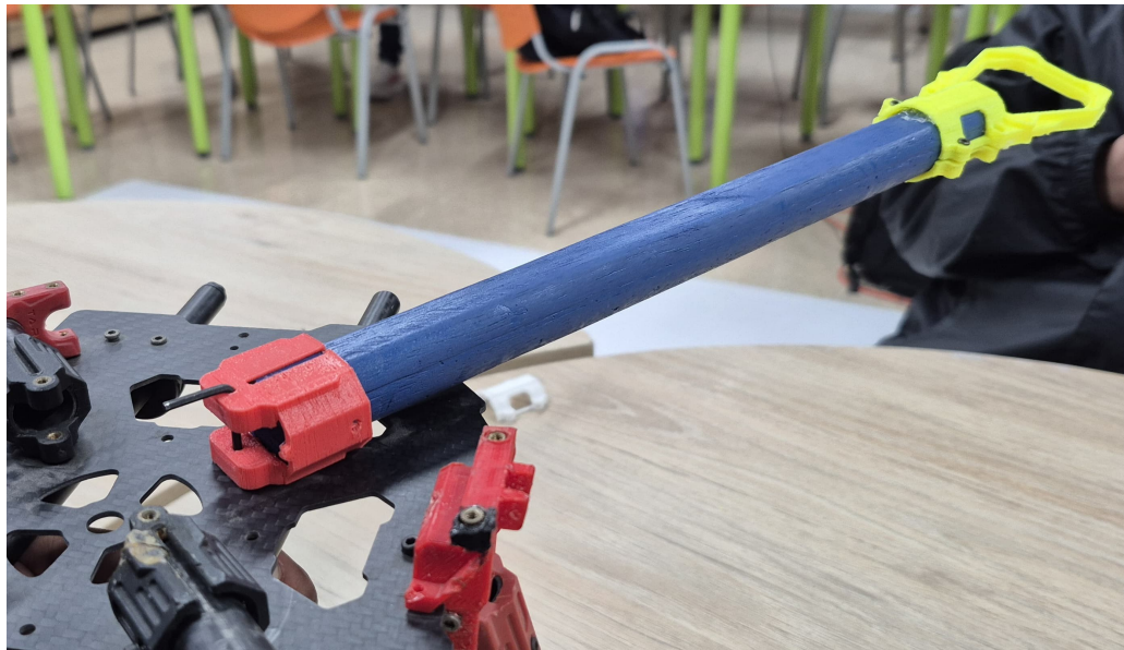
Figura 3.8.3: Brazo prototipo del dron ensamblado. Elaboración propia
