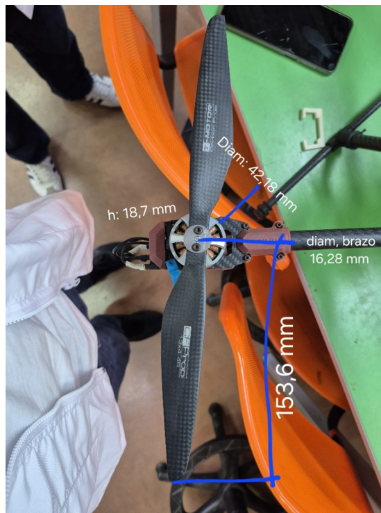
Figura 3.1.1: Vista superior del motor y hélice con medidas principales. (Fuente: Elaboración propia)
