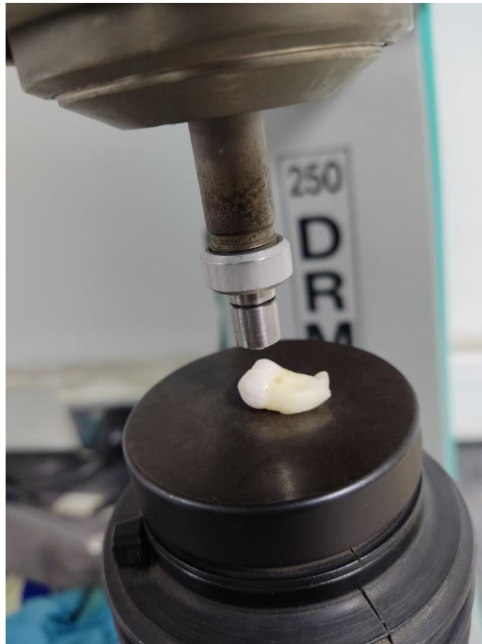
Figura 3. Diente real sometido a ensayo de dureza
