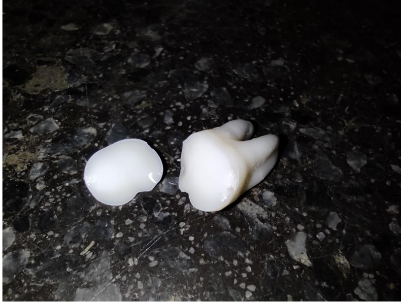
Figura 12. Molar fracturado tras someterse a ensayo de dureza Fuente: Imagen propia (2023)
