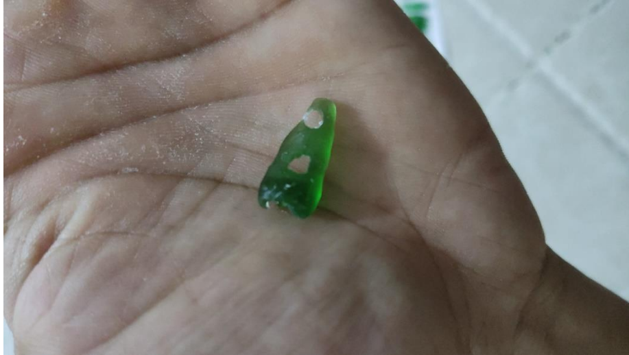
Figura 11. Diente con defecto de impresión
