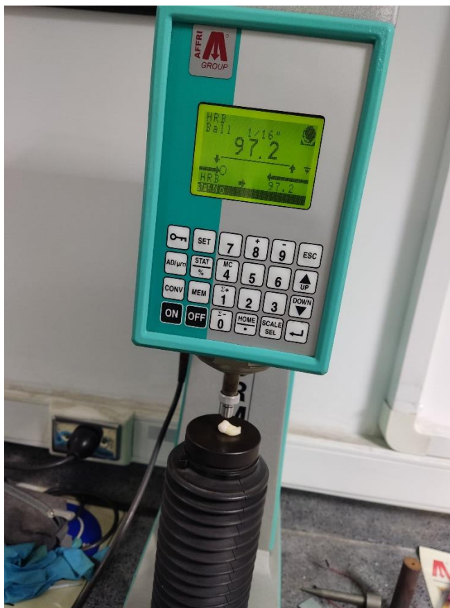
Figura 4. Resultado de dureza Rockwell sobre diente real Fuente: Imagen propia (2023)
