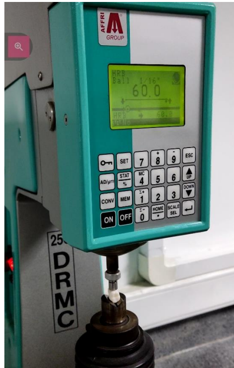
Figura 13. Resultado ensayo de dureza sobre molar de resina blanca Fuente: Imagen propia (2023)
