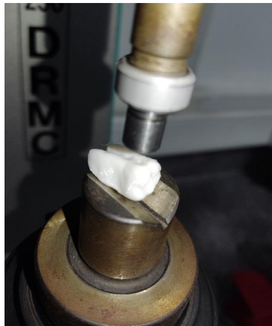
Figura 14. Molar en resina blanca luego de ensayo de dureza Fuente: Imagen propia (2023)
