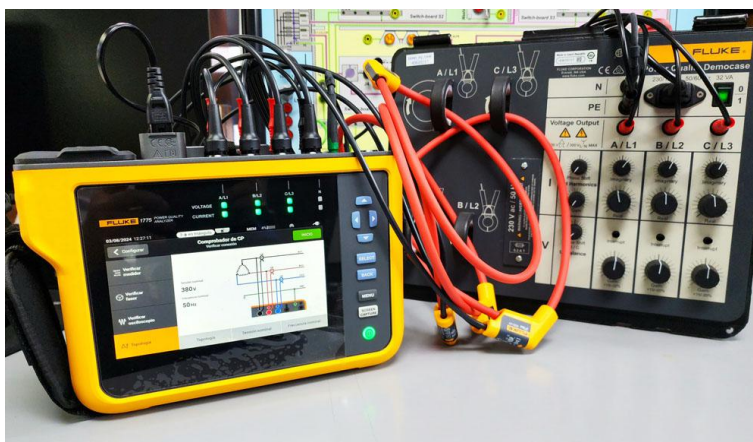
Figura 2. Analizador de potencia.
