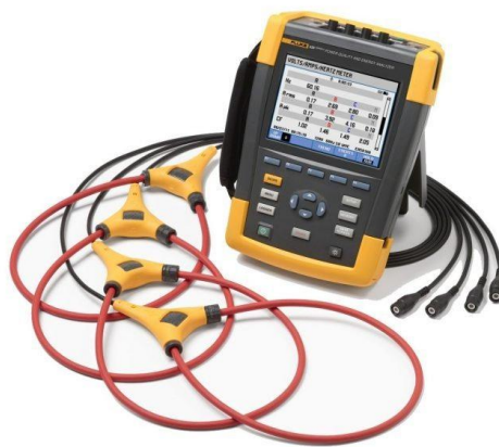
Figura 10. Analizador de energía FLUKE 434.
