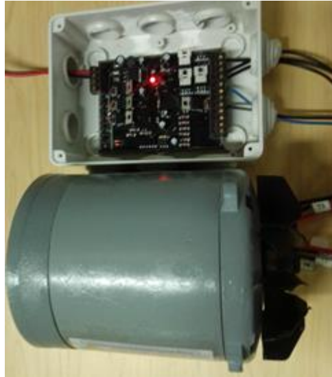
Figura 14. Imagen del modulo embebido y el motor de prueba. Fuente: diseño propio
