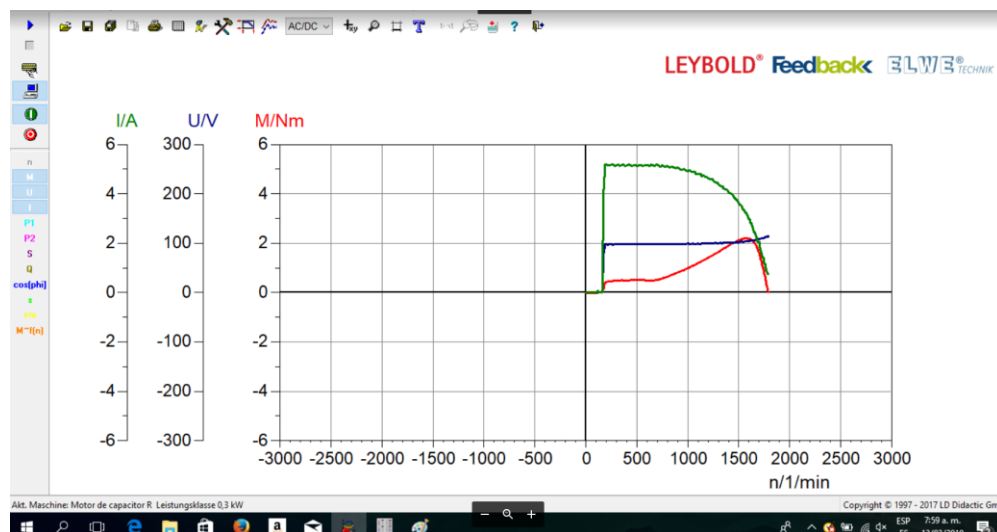
Figura 16. Curvas de la operación del motor de inducción durante las pruebas.
