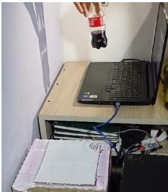
Figura 18. Detección de objetos aprovechables con contenedor cerrado Fuente: elaboración propia
