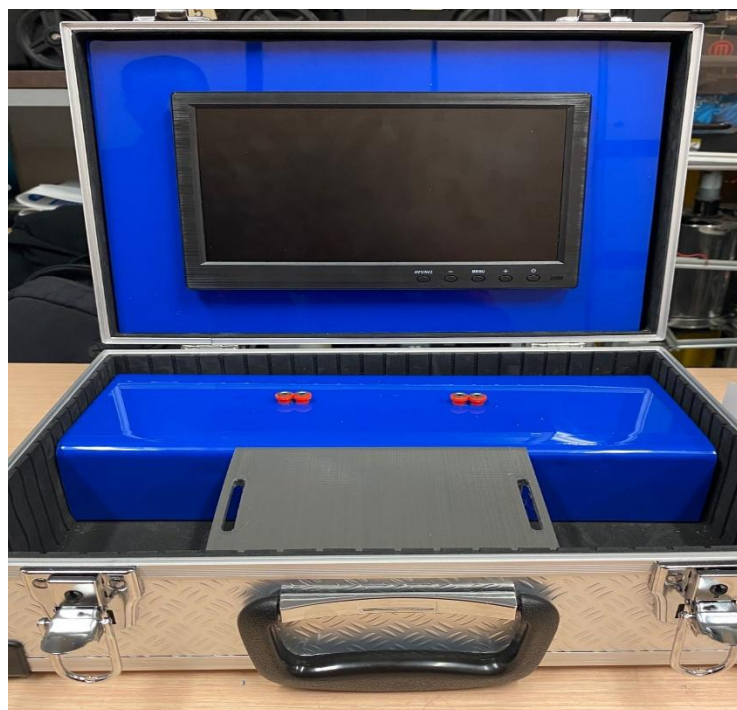
Figura 19. Maletín didáctico cerrado con monitor, conectores y módulo de prueba. Fuente: Propia.
