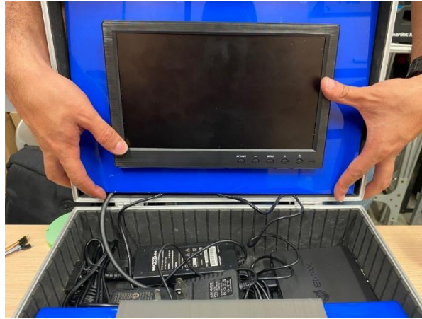
Figura 20. Maletín didáctico abierto mostrando conexiones internas. Fuente: Propia.
