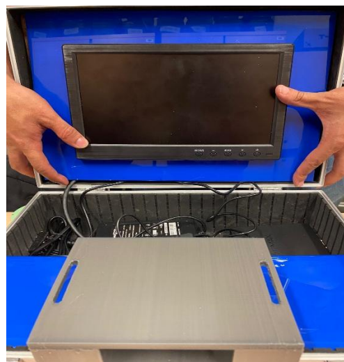
Figura 23. Maletín didáctico con pantalla instalada y modulo intercambiable.
