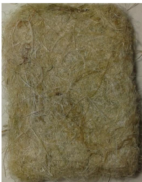
Foto 55. No tejido por vía seca-Punzonado de 4 capas Fuente: Geraldine Jimenez
