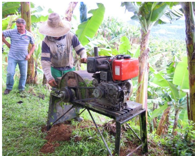
Foto 27. Máquina desfibradora de fique Fuente: Martha Álvarez
