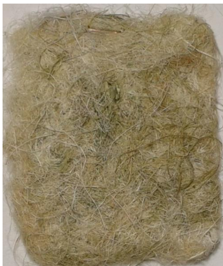
Foto 54. No tejido por vía seca-Punzonado de 2 capas Fuente: Geraldine Jimenez
