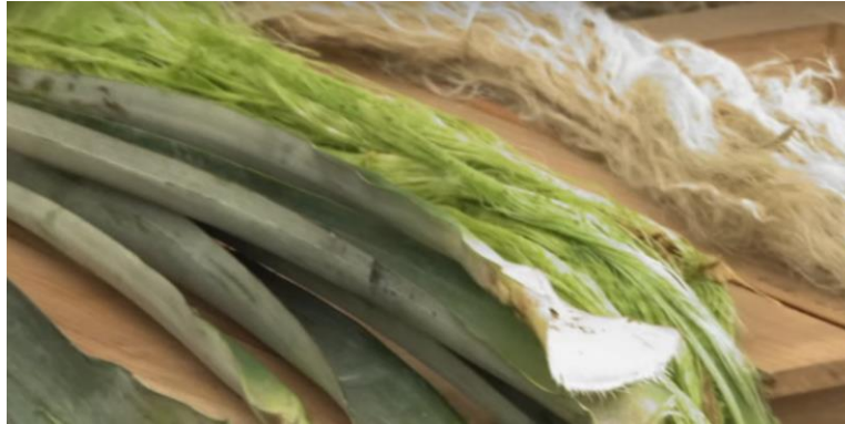
Foto 15. Hoja de la piña, fibra recién extraída y fibra seca Fuente: Universidad Tecnológica de Costa Rica
