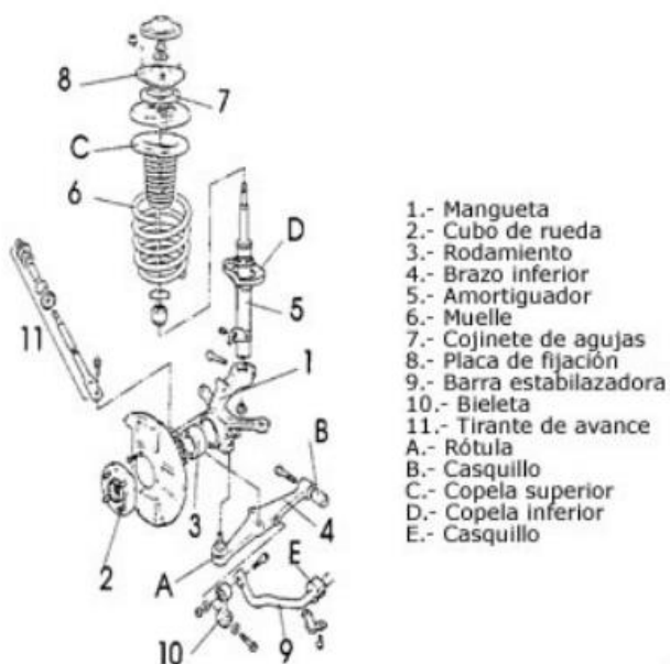
Figura 1: despiece de un sistema de suspensión McPherson. [4]
