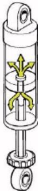
Fig. 5. Esquema de un amortiguador hidráulico con sistema de válvula de apertura por área.[7]
