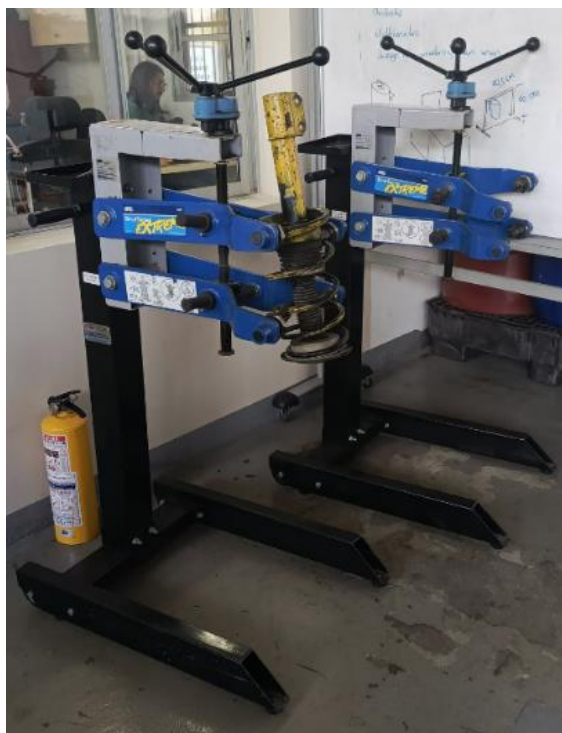
Fig. 2: Compresores disponibles actualmente en el laboratorio LIDA. (fuente propia).
