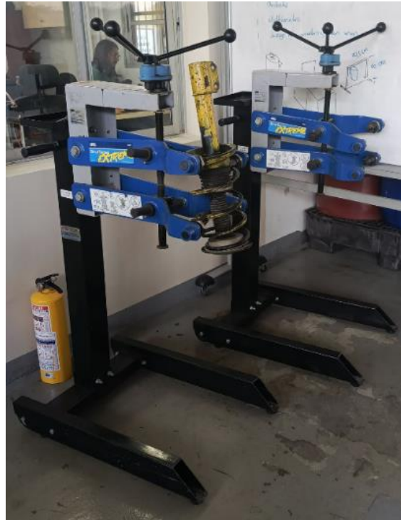
Fig. 10: Compresores disponibles actualmente en el laboratorio LIDA. (fuente propia).
