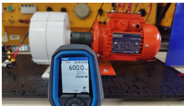
Figura 20 Medición 600 RPM - Generador
