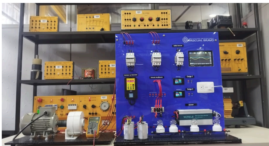
Figura 16 Verificación del módulo para prueba en vacío Fuente: (Diseño por Romario Illera, Jonathan Mesa, Carlos Marin)
