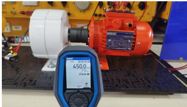
Figura 19 Medición 450 RPM - Generador
