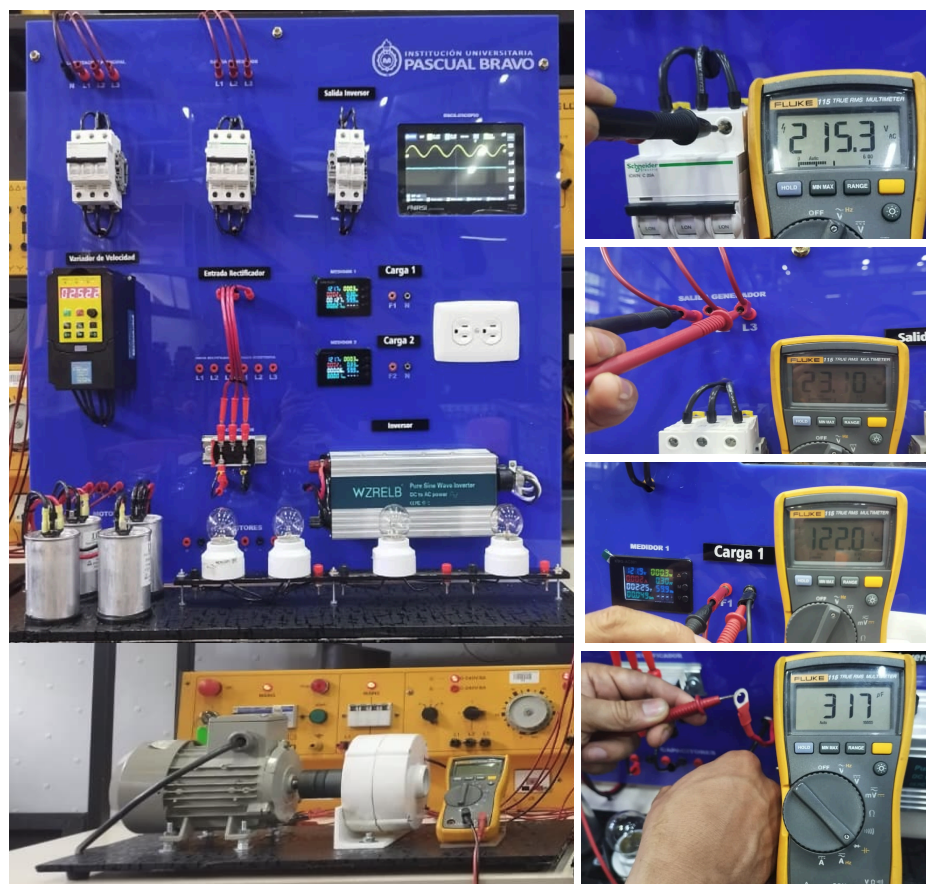
Figura 27 Verificación del módulo - valores nominales
