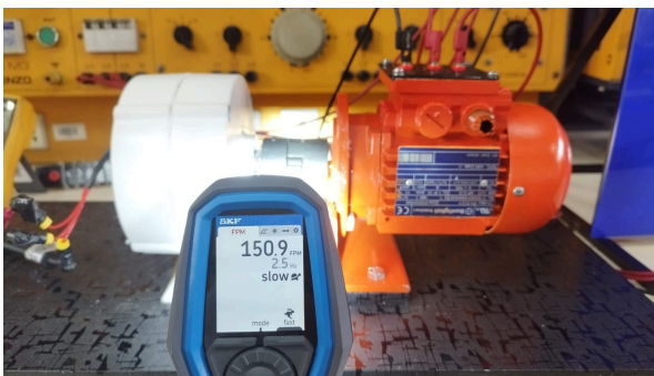
Figura 17 Medición 150 RPM - Generador Fuente: (Diseño por Romario Illera, Jonathan Mesa, Carlos Marin)
