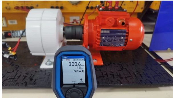
Figura 18 Medición 300 RPM - Generador
