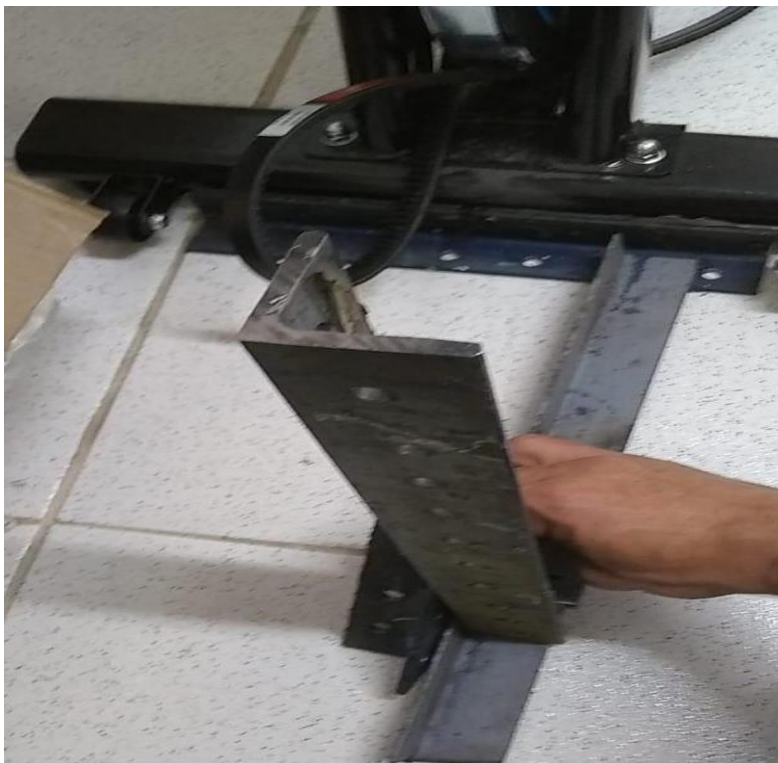
Figura 13. Ensamble de sistema de transmisión y soporte mecánico estructural por medio de ángulos en L Fuente: diseño propio
