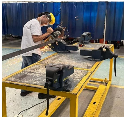
Figura 11. Proceso de manufactura de platinas para soporte de prototipos estructurales Fuente: elaboración propia
