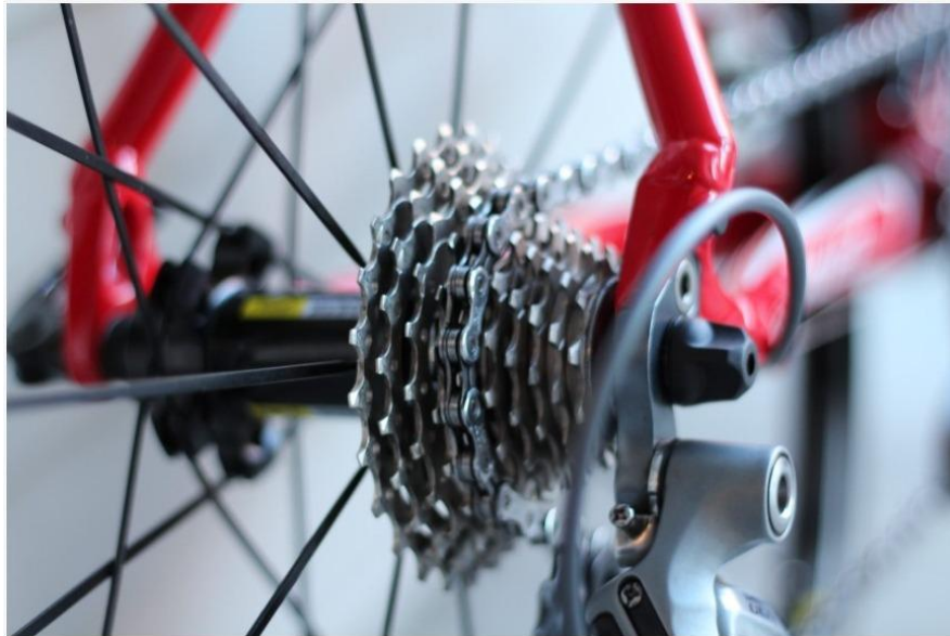
Figura 9. Transmisión de una piñones, platos y cadenas
