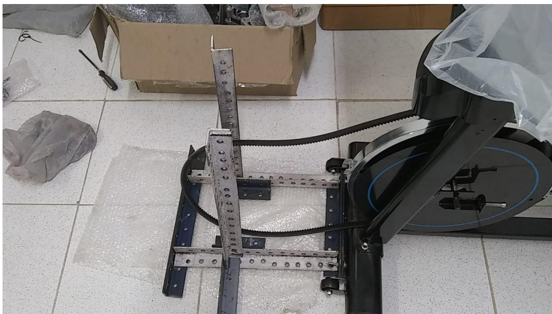
Figura 14. Ensamble de sistema de transmisión y soporte mecánico estructural con banda adaptada a rueda conductora principal de la bicicleta tipo spinning Fuente: diseño propio
