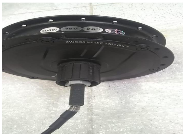
Figura 17. Motor eléctrico de engranaje sin escobillas 48V 500W usado en prototipo 1 Fuente: diseño propio
