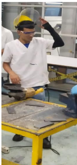
Figura 19. Adecuación de pulidora con guarda de seguridad – esta es la herramienta principal usada para realizar cortes de perfiles de acero inoxidable como elementos de protección personal se usaron gafas, careta, protección auditiva y mangas de tela para protección de ojos, cara, oídos y manos
