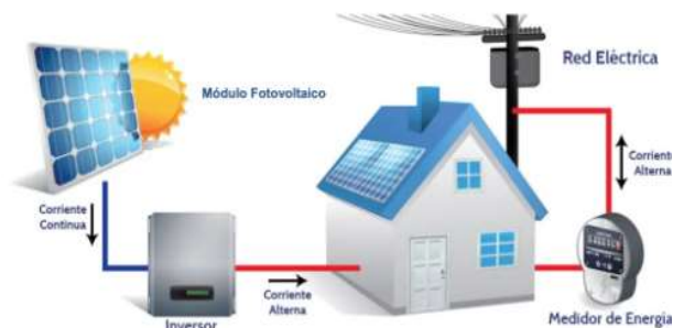
Figura 2 Sistema solar fotovoltaico conectado a la red eléctrica
