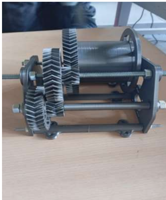
Figura 17: Mecanismo de tracción armado parte trasera Fuente: Elaboración propia
