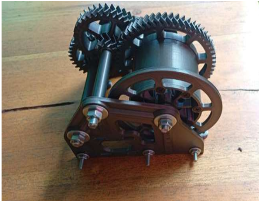
Figura 16: Mecanismo de tracción armado lateral Fuente: Elaboración propia
