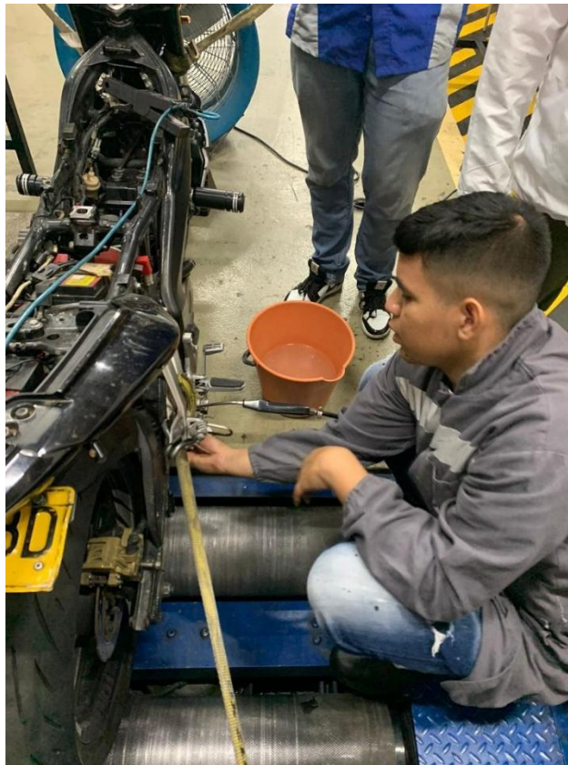
Figura 5. Toma de gases de escape según la NTC 5365.
