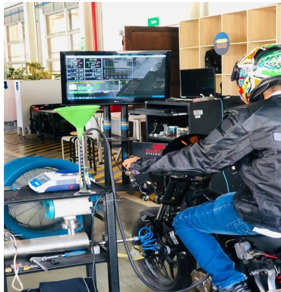
Figura 7. Prueba de consumo en el dinamómetro de rodillo
